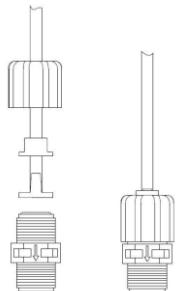
**I Aspirazione:** Collegare l'altro capo del tubo PVC Crystal morbido all'aspirazione della pompa (parte inferiore del corpo pompa), svitare la ghiera dal raccordo e far passare il tubo attraverso la ghiera, quindi il ferma tubo ed infine inserire con un'azione contemporanea di pressione e rotazione il tubo fino in fondo sull'attacco conico del raccordo (portagomma); bloccare il tutto serrando a fondo la ghiera.
